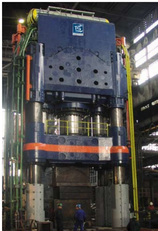
Rekonstrukce řízení hydrauliky a ovládání čtyřsloupového kováčích lisu CKV 12000 pro firmu Vítkovice, ČR
